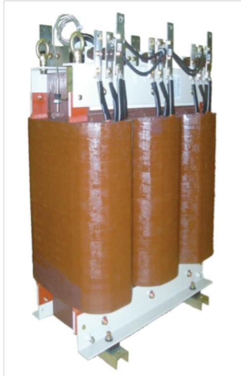
データセンタ内の電源設備であるサーバ室低圧電力分電盤（PDU: Power Distribution Unit）に収納される低圧の変圧器（PDU盤用モールド変圧器）です。約1,120台の納入実績があります。（H29/3現在）F種モールドタイプを適用することによって、損失を減らしエネルギー効率を上げて省エネを実現しました。
