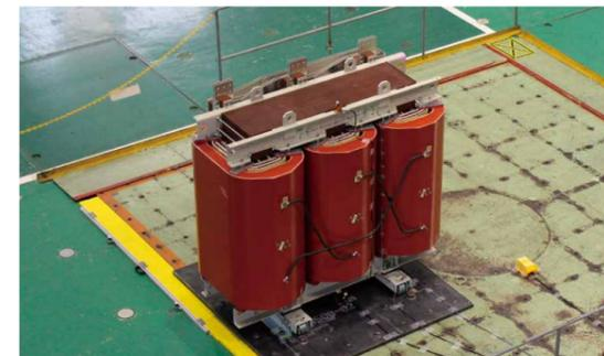
「配電用変圧器の変位量抑制指針」JEM-TR252に準拠し、静的耐震強度および、端子の変位量を転倒試験により検証。
